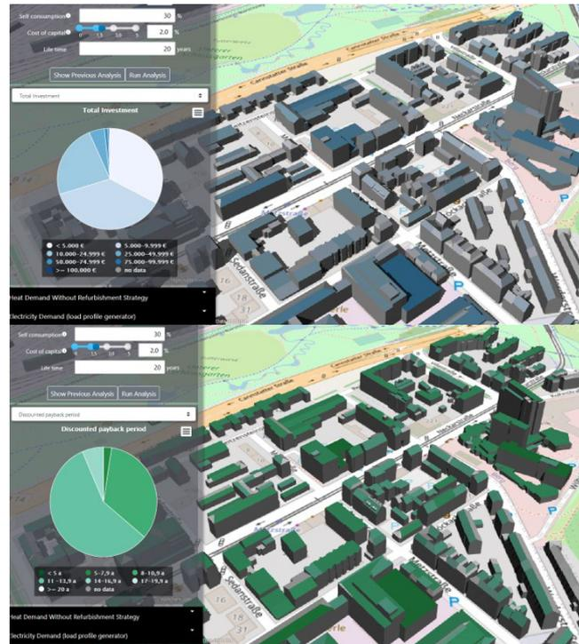
Abbildung 15: iCity MUSI – Auszug einer 3D Visualisierung des Stadtteils Stuttgart Stöckach mit Wirtschaftlichkeitsberechnung für PV Anlagen pro Dachfläche (oben: Investition pro Dachfläche in €; unten: Amortisationszeit in Jahres (a))
